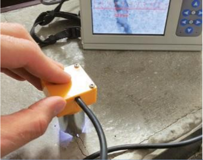
Nahoře: Měření trhlin po smrštění plastu digitálním mikroskopem Dole: Tlaková vrstva vytvořená pomocí Výztuž do betonu Durus EasyFinish
